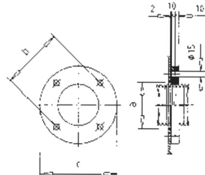
Schienen / Barres / Busbars – Ø 55 / 67 / 80 / 106
